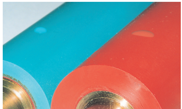
合成ゴムローラー(左)とレッド hidroメトリックローラー(右)の水濡れ状態比較 comparison of wet condition between synthetic rubber roll(left) and Red Hydro Metric roll(right)
